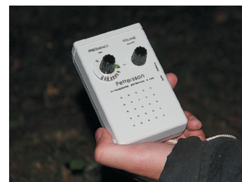
Ультразвуковой прибор для учета рукокрылых
